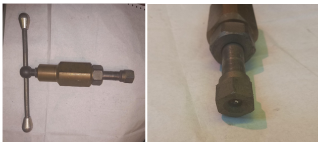
Рис. 4. Оснастка для формирования уплотнителя из индия.
